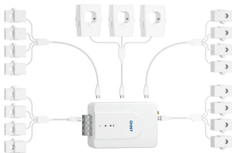
为实现楼宇内各楼层、各区域照明、插座、空调等需要大量回路进行用电监测的场景，现有多功能电表只能针对单回路进行计量和监测，存在安装和维护成本较高的痛点；而正泰多回路电计量网关可以最多同时计量19个回路，大大减少了传统单相电表的数量和安装工作量，从而整体上降低了设备采购、安装和维护的成本，并且计量网关内部集成485、以太网、4G等通讯方式，通过配套的移动端APP或WEB平台可实时查看各个回路的用电数据，实现多回路的电量监测，发现用电异常，制定合理的用电计划，助力双碳目标的达成。
